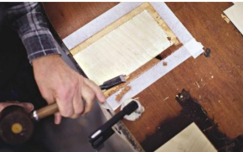
**Operation** Die zerstörte Sitzschale erhält eine passgenaue Furnier-Transplantation **Schablonen** Um ausgerissene Verbinder, sogenannte Shock-Mounts, zu ersetzen, wird individuell Maß genommen
