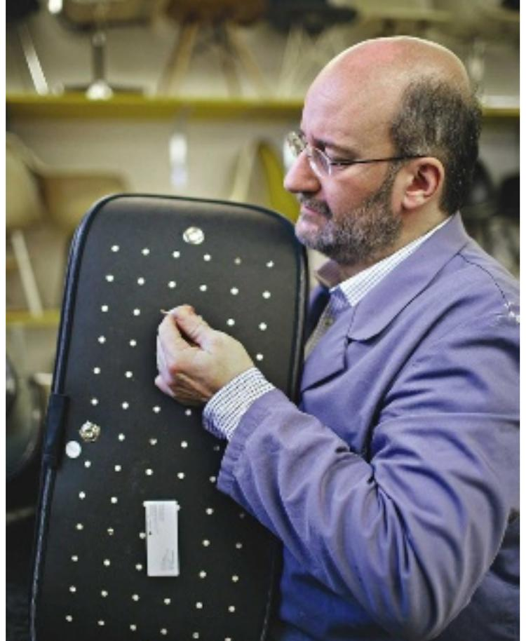
**Ein Mann hakt nach** Die perforierte, luftdurchlässige Polsterung der Kopfstütze wird mit Druckknöpfen aus Messing in der Formholzschaie fixiert. Jedes wiederhergestellte Bauteil wird von Stefan Thoma zertifiziert
